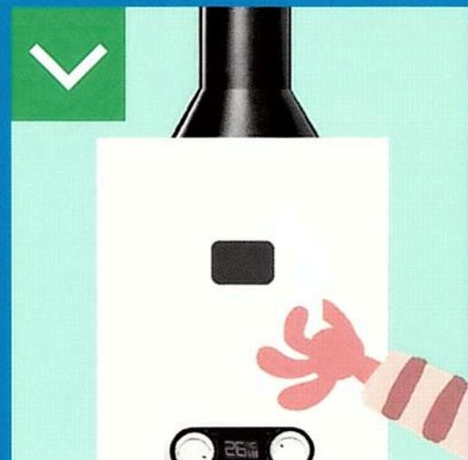
Для проверки тяги в дымовых каналах
